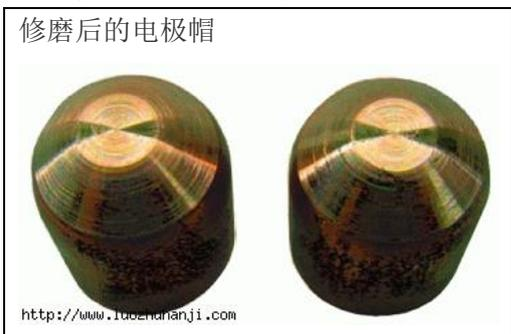
2. 使用寿命长，平均每把刀片可进行 4000 次以上的电极帽修磨工作；
